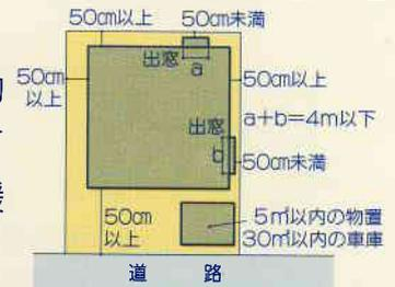
1. 住宅に付属する物置その他これに類する建築物で、軒の高さが2.3m以下、かつ床面積の合計が5.0㎡以内のもの。
